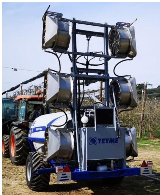
Figura 4. Polvoritzador de flux tangencial generat per sis ventiladors accionats hidràulicament. Primavera de 2020. Foto: TEYME TECNOLOGIA AGRÍCOLA, SL.
