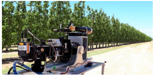
Figura 7. Emissor LiDAR de doble feix utilitzat en el mesurament de la deriva aèria (Mollerussa, 16 de juny de 2019). Foto: S. Planas.
