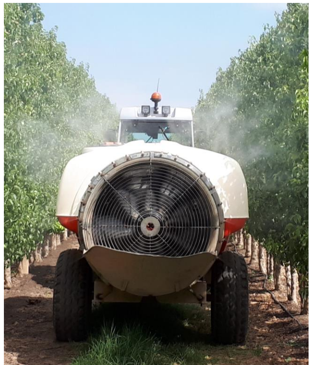
Figura 8. Polvoritzador convencional Tifone 2000 durant el mesurament de la deriva amb el sistema LiDAR (Mollerussa, 17 de juny de 2019). Foto: S. Planas.
